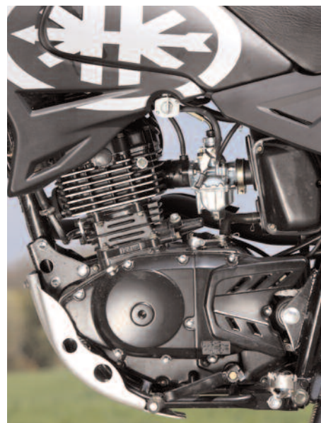
Einem Suzuki-Triebwerk „nachempfunden“: der luftgekühlte Viertakt-Einzylindermotor
